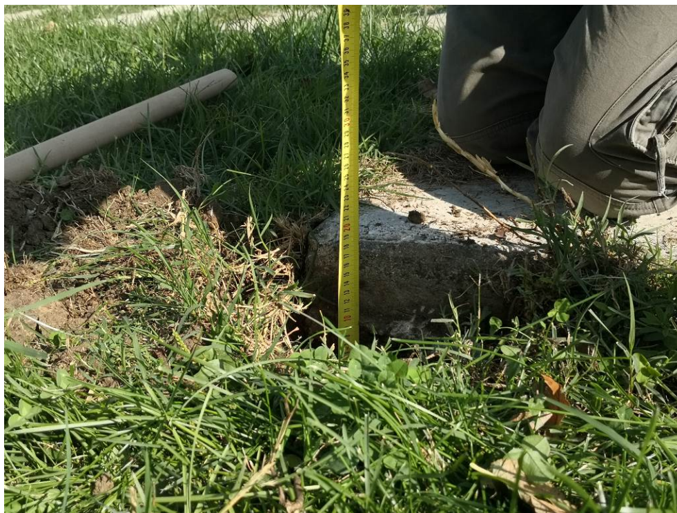
Foto 4: determinazione spessore fondazione
